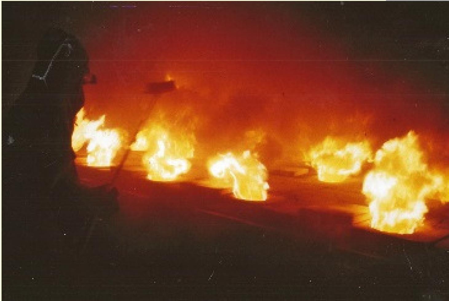
Salzbrandofen mit geöffneten Zugöffnungen zum Einfüllen von Salz
